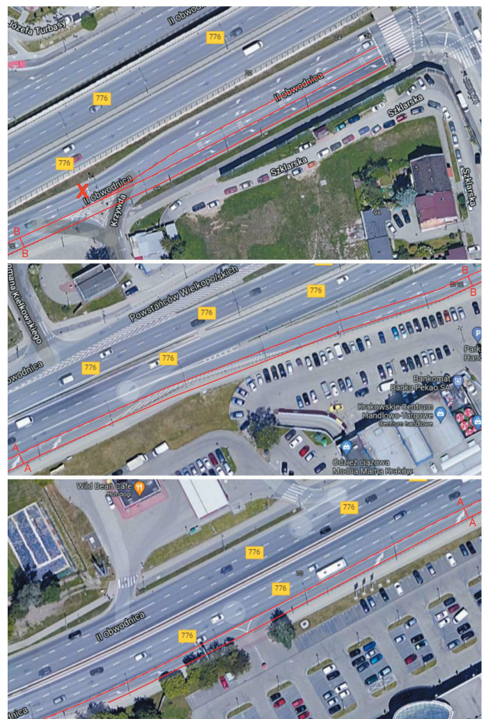
Fot. 3. Propozycja wyznaczenia pasa autobusowego i ewentualnie do skrótu w prawo na wlocie ulicy Powstańców Wielkopolskich na skrzyżowanie z ulicą Kuklińskiego Źródło: opracowanie własne na podst. Map Google [19]
