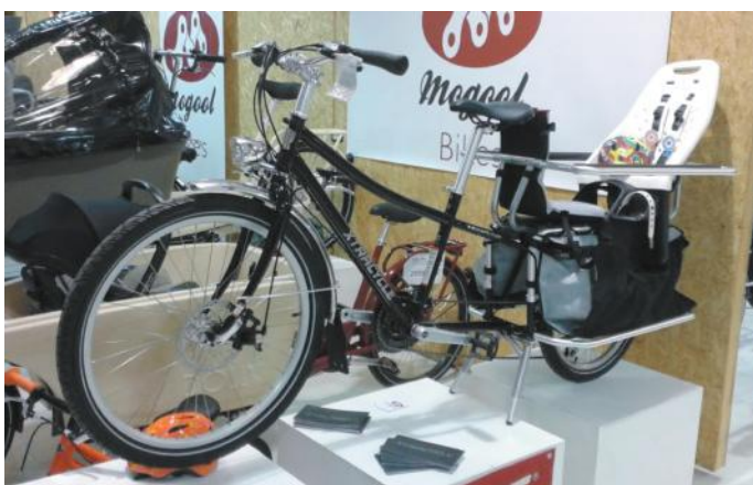
Fot. 4. Rower towarowy typu Long tail Źródło: archiwum prywatne autora
