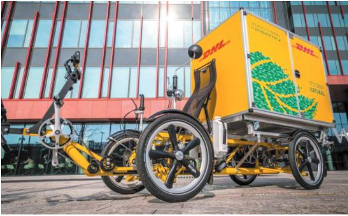
Fot. 6. Czterokołowy rower towarowy Źródło [300]
