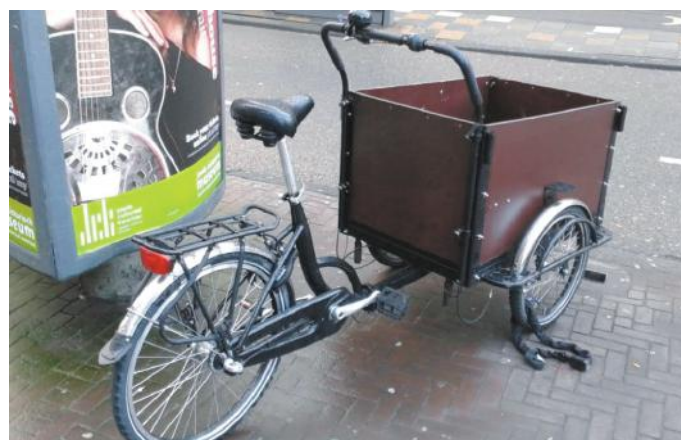
Fot. 5. Trójkołowy rower towarowy ze skrzynią ładunkową ulokowaną z przodu Źródło: archiwum prywatne autora
