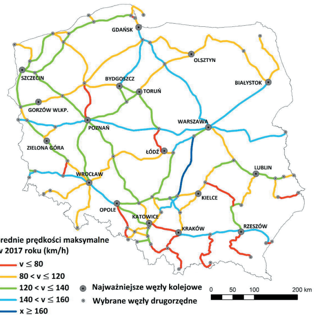
Rys. 2. Średnie prędkości maksymalne na wybranych liniach kolejowych w 2017 roku Źródło: opracowanie własne na podstawie danych PKP PLK [16]
