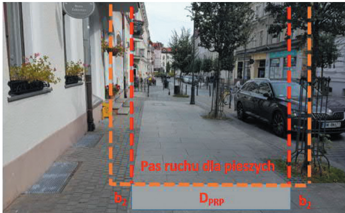
Rys. 20. Pas ruchu dla pieszych – schemat ustalania szerokości, Źródło: opracowanie własne
