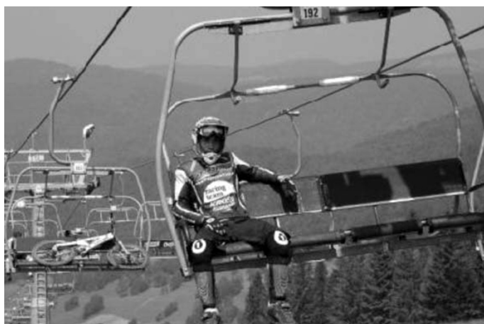
Fot. 2. Przewóz roweru na krzesełku poprzednim lub następnym w stosunku do kolarza [1]
