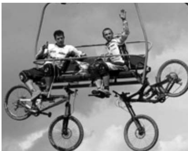
Fot. 7. Przewóz zawieszono go roweru poprzez zahaczenie przodem siodełka o płaszczyznę poziomą siedziska krzeselka [5]
