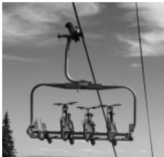
Fot. 9. wykorzystanie specjalizowanych krzesełek do transportu rowerów [5]
